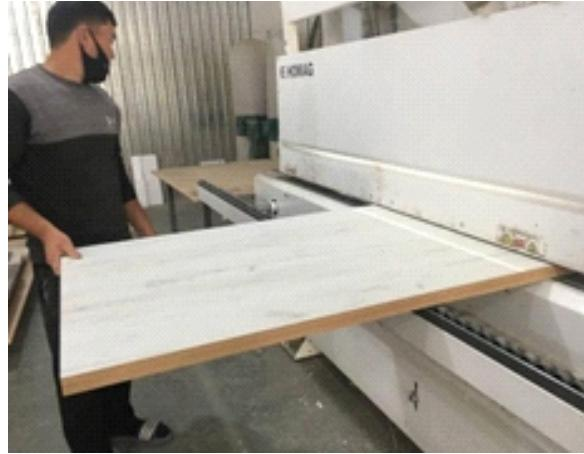
Детали кромятся. Процесс кромления также автоматизирован. Причем кромка делается только на видные части, на стыковочные части кромка не наносится.
