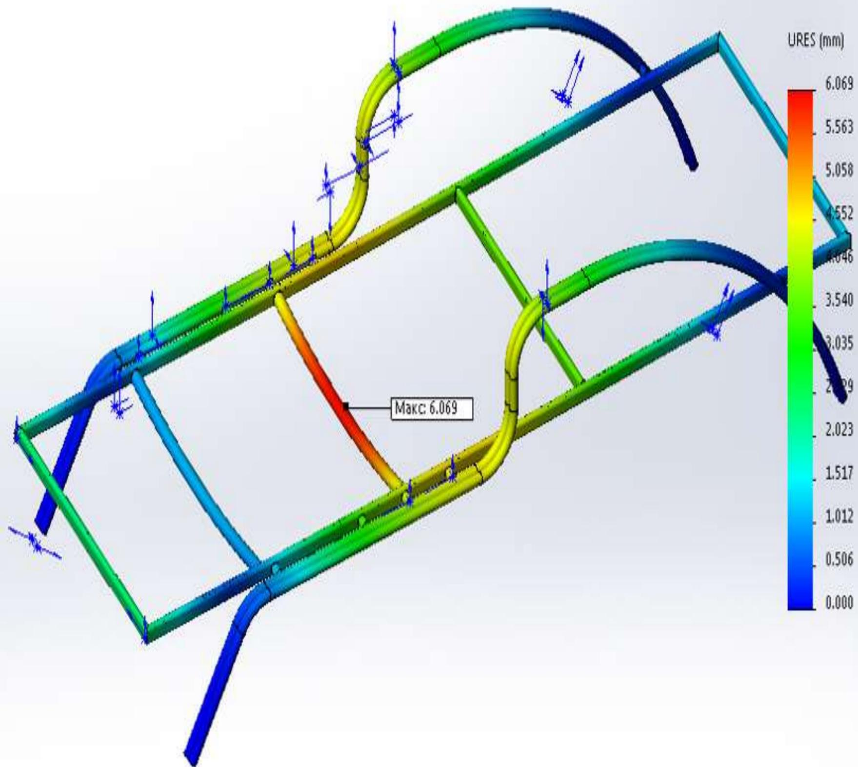
**В специальных программах создается имитация грузоподъёмности и эксплуатации модели до выпуска в линейное производство. Каждая модель проходит обязательную проверку в симуляции с давлением веса на каждый шов в соответствии с минимальными требованиями ГОСТ.**
